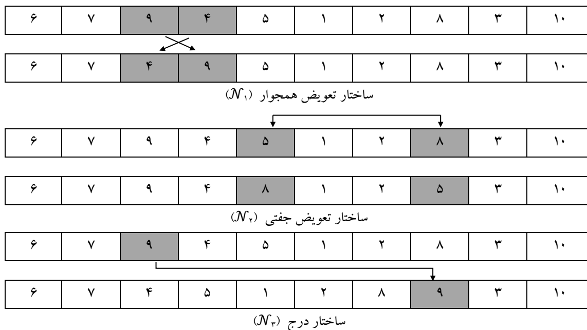
شکل ۴. ساختار همسایگی‌ها در الگوریتم جستجوی محلی
