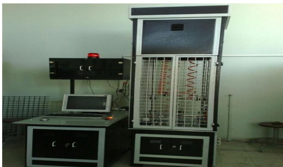
شکل ۵. دستگاه تست ضربه
