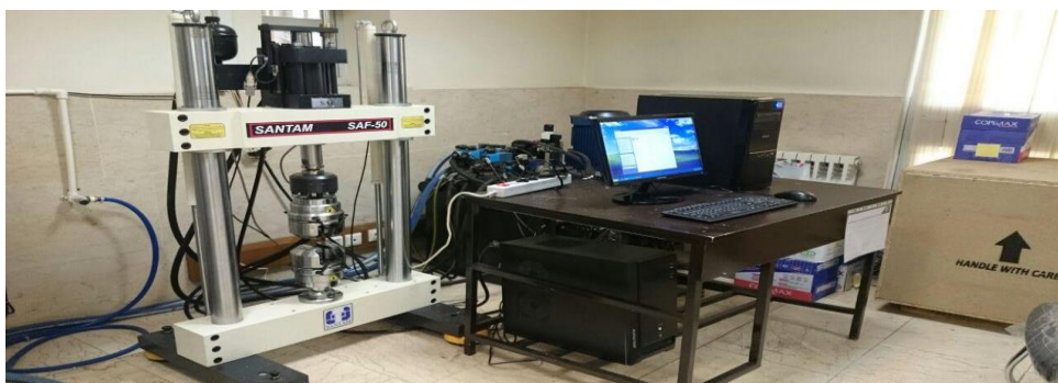
شکل ۶. دستگاه تست خستگی
